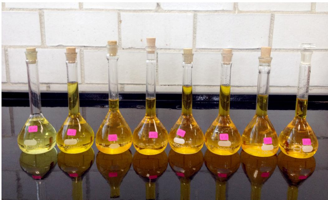
Figura 4. Serie de matraces de las soluciones de la curva patrón de fosfatos
