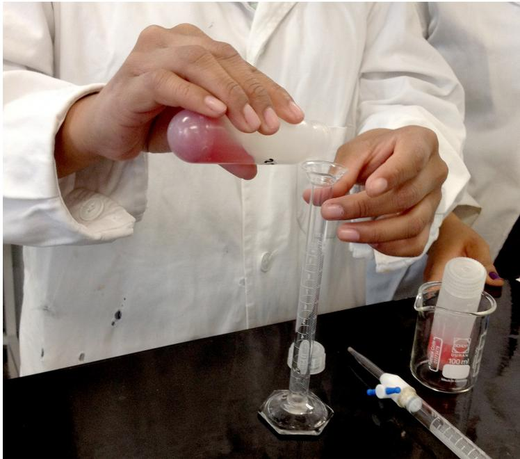
Figura 1. Determinación de CRA por centrifugado y decantado.
