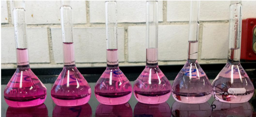
Figura 3. Serie de matraces de las soluciones de la curva patrón de nitritos
