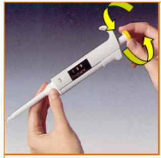
Figura 17-E. En el caso de las micropipetas BIOHIT solamente se deberá girar el émbolo hasta que el volumen deseado aparezca en la pantalla.
