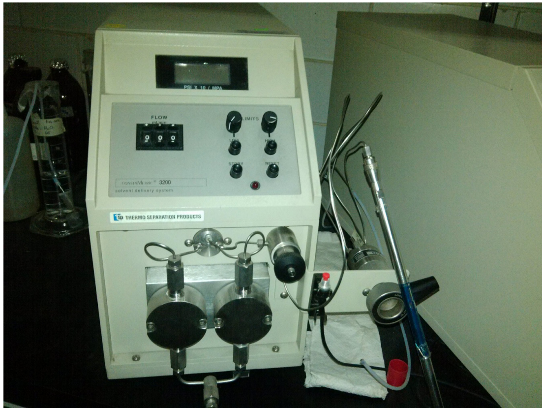
Figura 14. Modulo de bomba binaria, para separaciones isocráticas.
