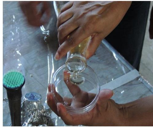
Figura 6. Forma de vaciar el medio a las cajas de Petri, cuidando que al bajar la caja no se impregne de medio la tapa.
