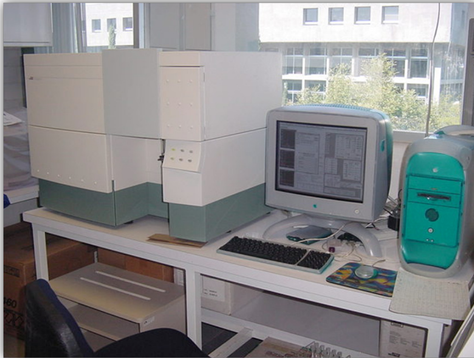
Figura 5.- Citómetro de flujo modelo FACScalibur, equipado con un láser de argón (488nm) y láser de diodo rojo; con habilidad de detectar dos formas de dispersión de la luz, cuatro diferentes fluorescencias y capacidad de separar selectivamente y coleccionar células ("sorting").
