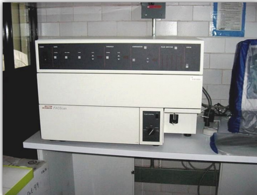
Figura 4.- Citómetro de flujo modelo FACScan, equipado con un láser de argón (488nm); con capacidad de detectar dos formas de dispersión de la luz y tres diferentes fluorescencias.
